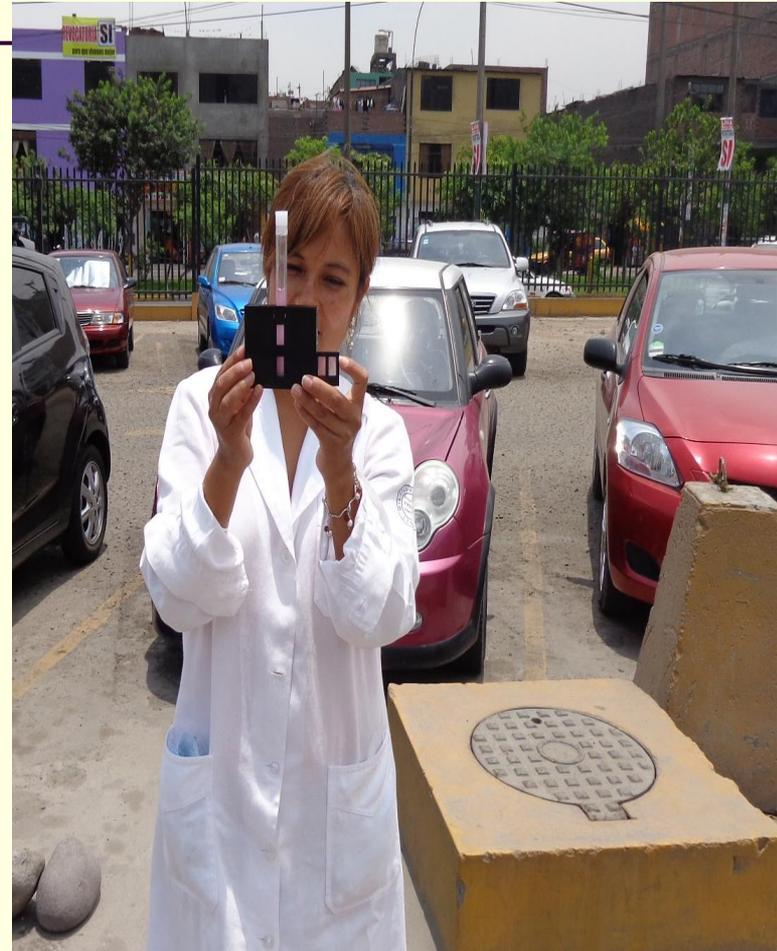
Se toma una muestra de agua para ser analizada mediante un colorímetro portátil diariamente.
