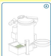
**La Descarga:** Después que una señal del equipo, haya informado al operador; que todas las condiciones de seguridad se cumplen. El operador, aprieta un botón para que se abra automáticamente la compuerta inferior de la Autoclave; dejando caer, por gravedad, los residuos (residuos triturados y esterilizados) a un carro contenedor colocado debajo de la Autoclave.
